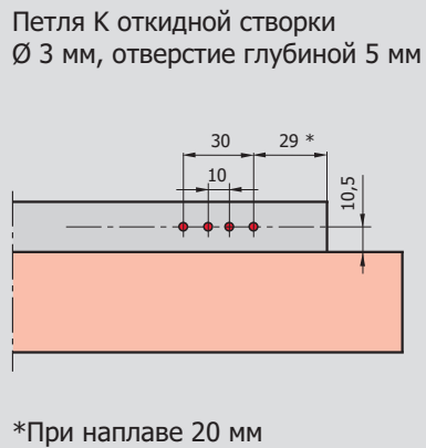
Петля откидной створки в наплав
